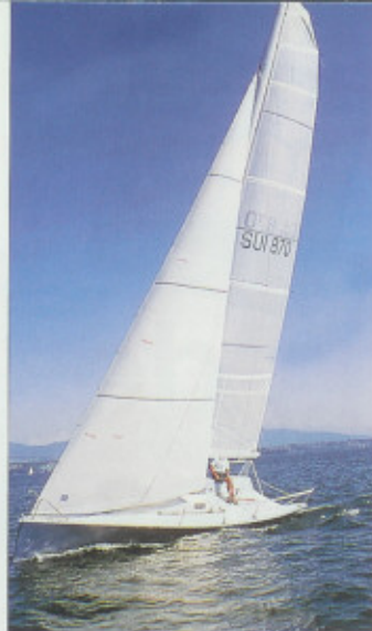
L'utilisation d'un mât aile pivotant, beaucoup plus rigide qu'un mât traditionnel, oblige à réviser sa façon de régler son bateau.
