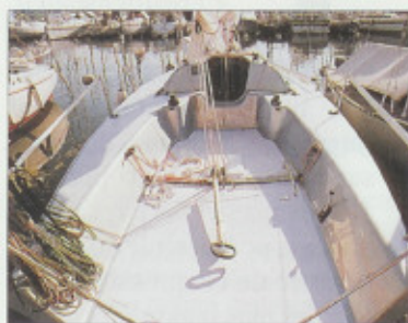
La largeur maximale du pont de 2,90 mètres permet à l'équipage un rappel efficace
